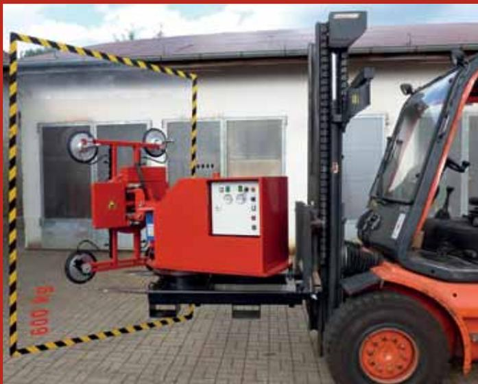
Neu bei uns im Programm ist der **GS-Glasboy 600**. Dabei handelt es sich um ein Anbaugerät, das an jeden Gabelstapler angebracht werden kann, um Glasscheiben oder auch andere glatte Teile zu transportieren.
